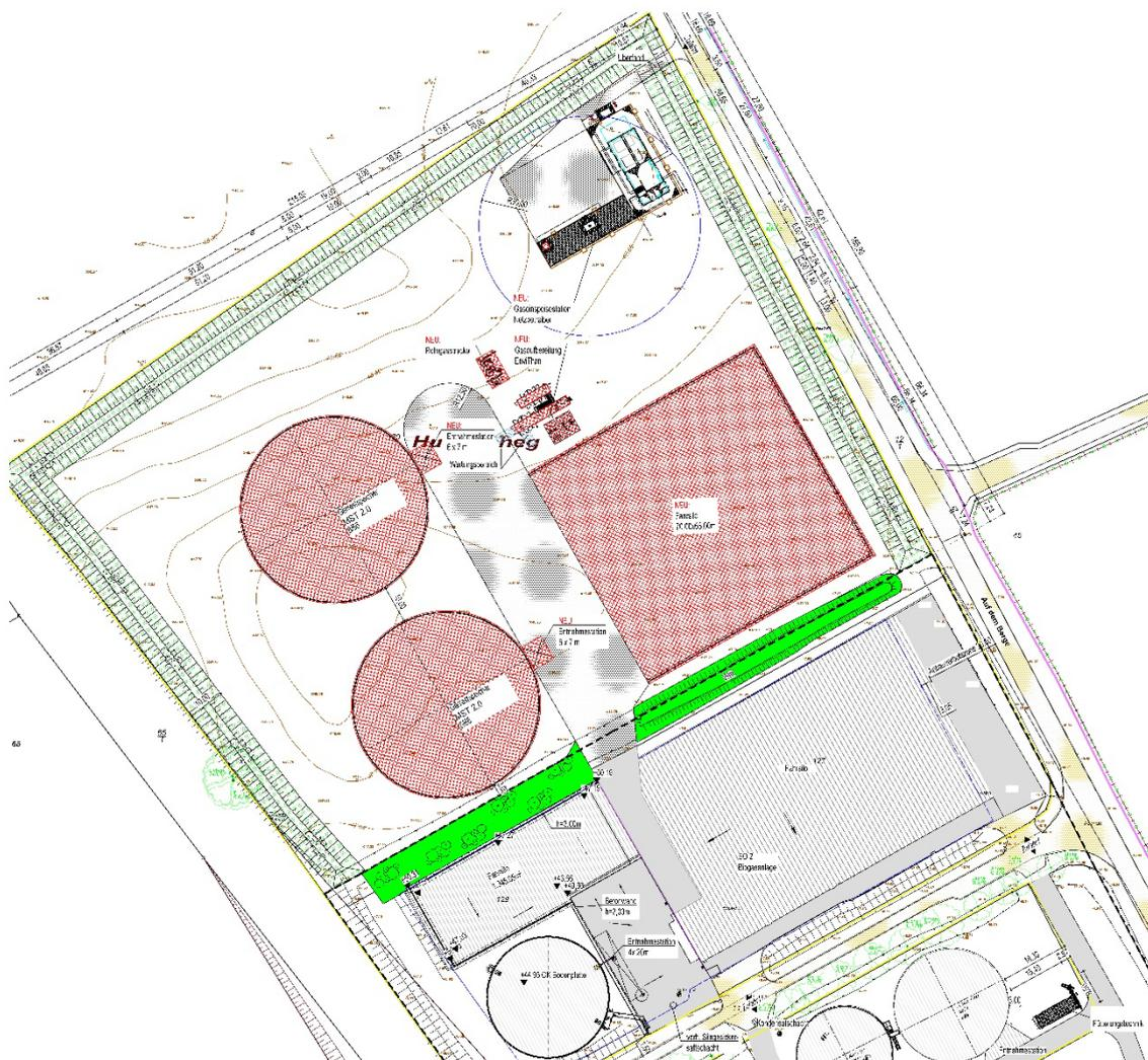
**Abb. 8: Ausschnitt Lageplan Erweiterung einer Biogasanlage von Lehmden Planungsbüro, Stand: 06.12.2022**
