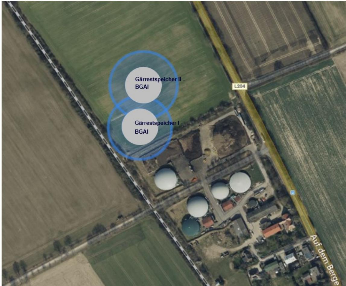
**Abbildung 7: Ausbreitung der toxischen Atmosphäre oberhalb AEGL-2 Wert ausgehend des Gärrestspeichers I-BGA I und II-BGA I – schemenhaft Windrichtungsunabhängig**
